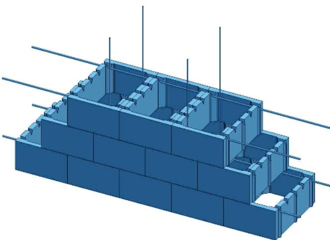
Svým provedením umožňují vzájemnou návaznost jednotlivých rozměrových typů. Součástí jsou i půlitelné tvarovky. Jednoduchý systém několikanásobného pera a drážky umožňuje pohodlné kladení a vyrovnání tvárnic i vzájemnou kombinaci různých tloušťek. Zabraňuje nežádoucímu příčnému posunu tvarovek při jejich plnění betonem.
