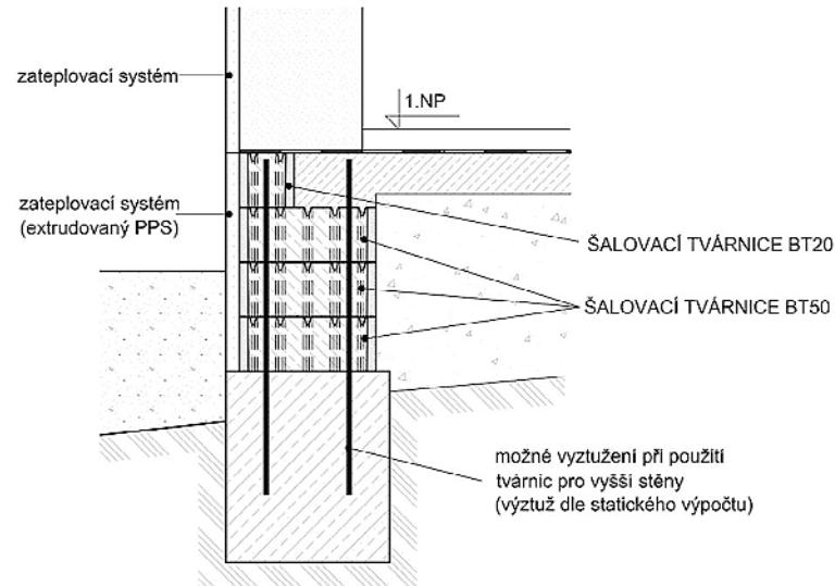
**Betonové tvárnice ztraceného bednění jsou deklarovány dle ČSN EN 15 435 - Betonové prefabrikáty - Bednící tvárnice z obyčejného a lehkého betonu.**
